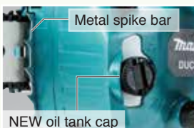
Chain oil level window Tingkap paras minyak rantai 链条油位视窗
